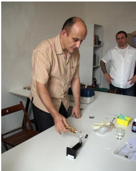
Bertrand Lavédrine testuje plasty nad příručním plynovým kahanem
