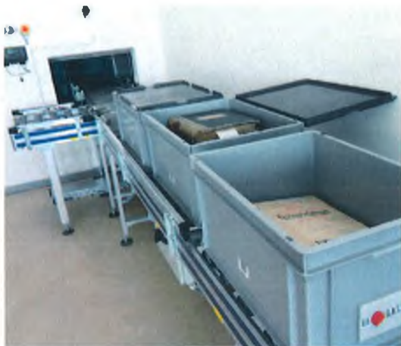
Abb. 16: Aktentransportanlage im Aktenübergaberaum.
