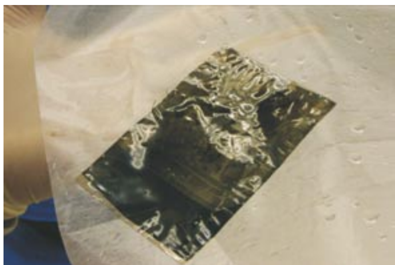
Obr. 5 Transport citlivé vrstvy na netkané textilii
