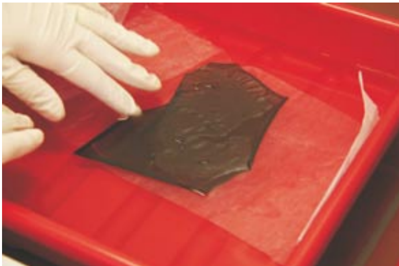
Obr. 6 Promývání samotné citlivé vrstvy v destilované nebo deionizované vodě. Pro lepší manipulaci je použita netkaná textilie
