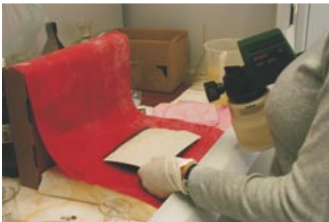
Obr. 19 Fixace 0,5 – 1% roztokem želatiny s přídavkem etanolu
