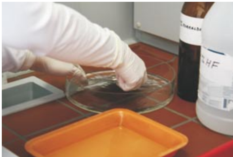
Obr. 1 Vložení negativu do lázně 2% roztoku formaldehydu
