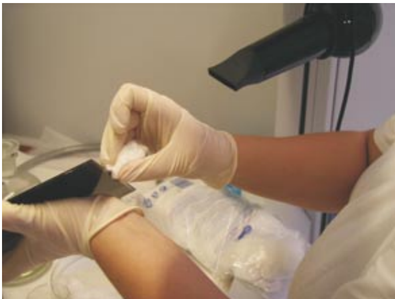
Obr. 5 Čištění hrany skla
