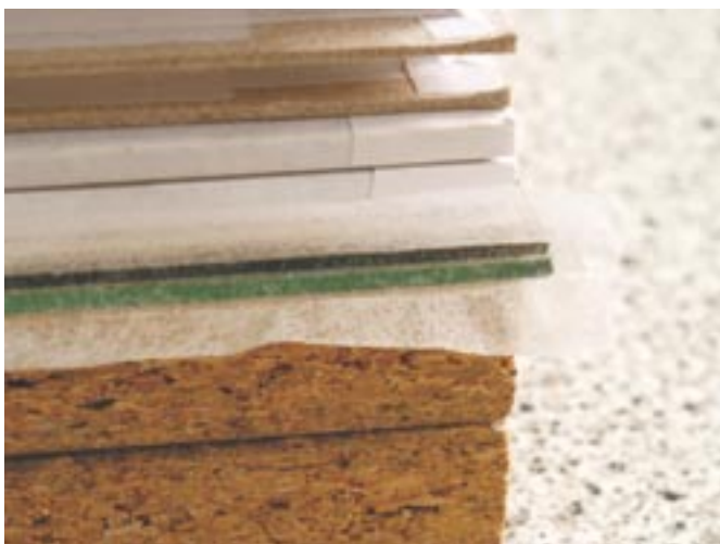
Obr. 12 Detail rohu po přilepení fixačního proužku japonského papíru
