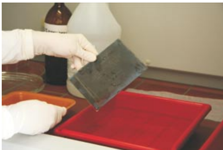
Obr. 2 Promytí negativu v destilované nebo neionizované vodě
