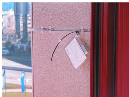
Obr. 4.1 Umístění indikačních kuponů při měření v jednom z depozitářů a na fasádě budovy Národního archivu v Praze na Chodovci
