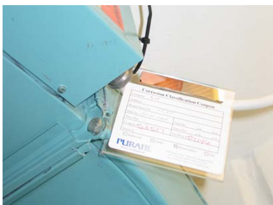
Obr. 4.1 Umístění indikačních kuponů při měření v jednom z depozitářů a na fasádě budovy Národního archivu v Praze na Chodovci
