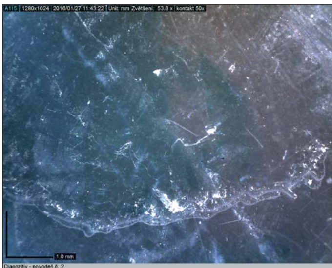
Makroskopický snímek kolorovaného diapozitivu se skvrnou na citlivé vrstvě s krystalickými rezidui nečistot po nedokonalém vyčištění. (A AV ČR, fond J. V. Daneš, č. 428/2)
