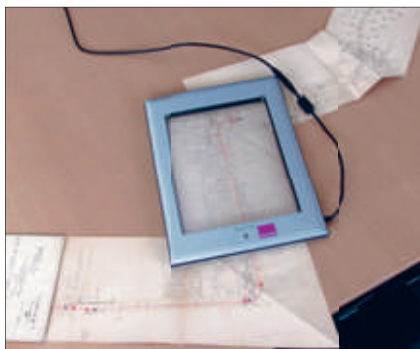
Obr. 5 – Situační plán okružní elektrické dráhy Praha–Žižkov–Vinohrady, 1895 (vlevo) a skenování nepravidelné situace postupným přikládáním průhledného skeneru (vpravo)
