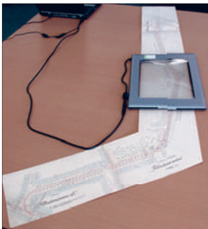
Obr. 5 – Situační plán okružní elektrické dráhy Praha–Žižkov–Vinohrady, 1895 (vlevo) a skenování nepravidelné situace postupným přikládáním průhledného skeneru (vpravo)
