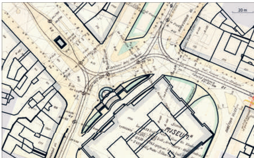
Obr. 28 – Detaily zobrazené na situačních plánech pouliční dráhy navíc oproti katastrální mapě (chodníky, pomníky, cestičky, osy kolejí, nástupní ostrůvky, sloupky osvětlení i vrchního vedení)
