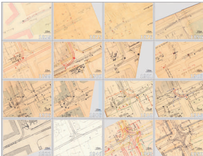
Obr. 8 – Normalizované výřezy stejné lokality (křižovatka Těšnov) z více map
