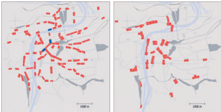
Obr. 12 – Hromadné změny zastávky v letech 1914–1917 (vlevo) a úpravy kvůli změně na pravostranný provoz v letech 1938–1939 (vpravo)
