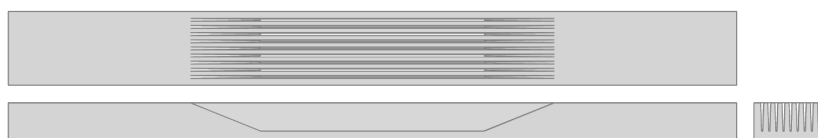
Obr. 6 Schéma modelových vzorků hydrogenovaného včelího vosku pro sledování efektu konsolidace. Rozměry tělesa: 80 x 8 x 4 mm. Štěrbiny jsou mírně kónické pro usnadnění odformování voskových odlitků.
